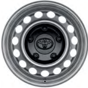
16"-Stahlfelge mit Bereifung 215/65R16
