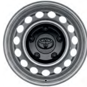
17"-Stahlfelge mit Bereifung 215/60R17
